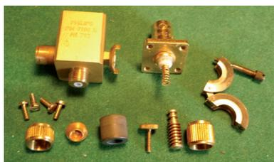
Bild 2: Einzelteile der Philips-Detektoren
