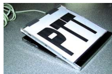
Deutlich zu erkennen: Diese Fußtaste schaltet die PTT des angeschlossenen Funkgerätes
