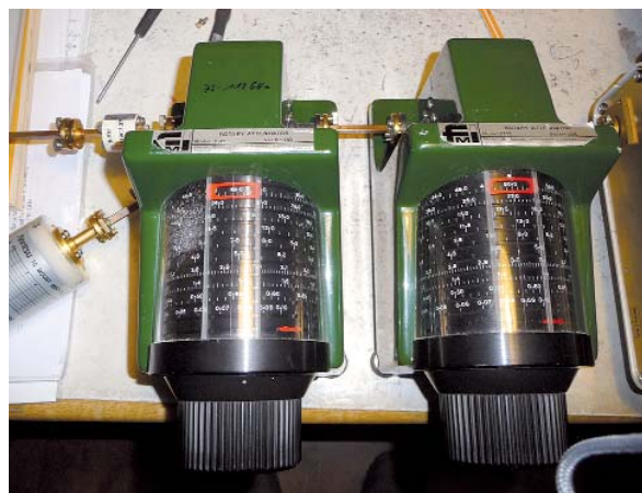
Bild 7 (links): Messeinstellung bei eingebauter Diode MA4E1318 für 76 GHz
