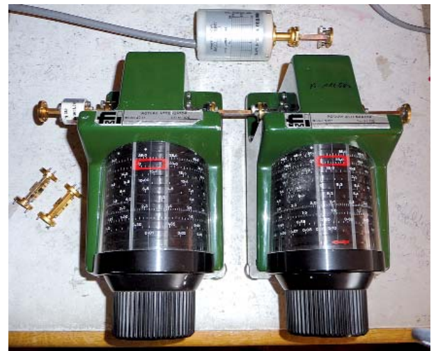
Bild 4: Der Attenuator Flann Rotary 2711 erlaubt bis 70 dB Absenkung
