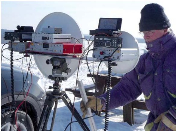
Bild 1 (links): Funkgeräte- Equipment für 76 und 122 GHz plus GPS-Empfänger beim Autor
