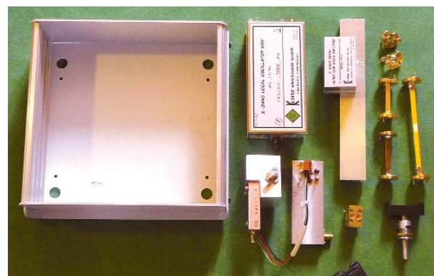
Bild 2: Aus diesen Teilen besteht hauptsächlich der Transverter
