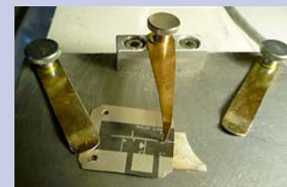
Bild 11: Löt-Hilfe für Micro-Bauteile
