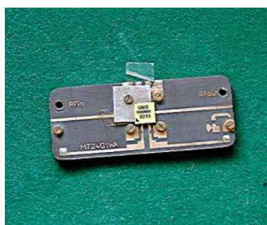
Bild 8: Der Endstufen-IC an seinem endgültigen Platz
