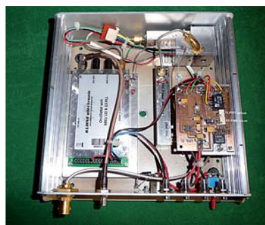
Bild 13: Aufbau 122 GHz Transverter
