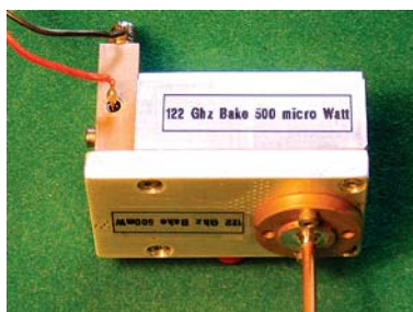
Die Bake mit 500 \mu\text{W} bei 122 GHz
