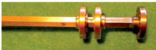
Bild 1: In Längsrichtung verschiebbarer Hohlleiter
